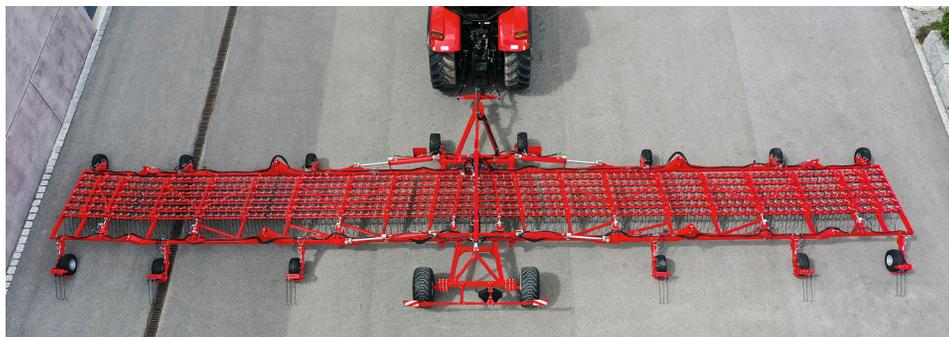
En complément des modèles portés qui culminent à 15 m et de la très grosse semi-portée de 24 m, Horsch inaugure la herse étrille Cura 18 ST d'une largeur de 18,20 m. Reprenant le châssis des modèles portés avec sept éléments, cette machine reçoit un essieu de transport à l'arrière autorisant l'utilisation d'un tracteur de 150 ch. Les dents de 8 mm sont espacées de 28 cm et
